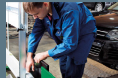
7. Der mega macs fordert dazu auf, die Platte in Position 3 einzuhängen. Anhand der folgenden Referenzmessung erkennt das Steuergerät die vertikale Position des Radarsignals. Der horizontale Abgleich erfolgt nach gleichem Muster.
