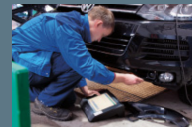
8. Auf dem Display des mega macs erscheint die genaue Anweisung, inwiefern korrigiert werden muss, z. B. „Schraube 1 (l. unten) um eine Viertelumdrehung nach rechts drehen“. Ist auch der zweite Radarsensor korrekt positioniert, initiiert der mega macs das Anlernen des Signals im Steuergerät.
