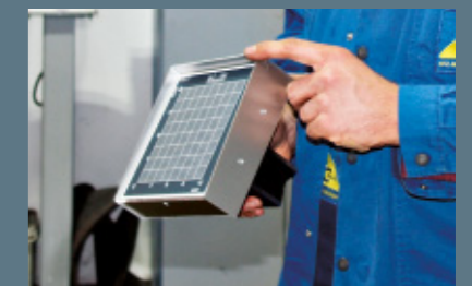
9. Bei älteren VW-Modellen (wie auch dem VW Touareg vor Bj. 2010) käme der, ebenfalls zum CSC-Radar-Kit 1 gehörende Laser-Aufsatz, zum Einsatz, der via Magnet einfach auf der Winkelverstellplatte fixiert wird.
