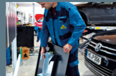
4. Die Winkelverstellplatte (Radarreflektor) verfügt über eine dreistufige Aufhängung, mittels der sie in positivem Winkel nach oben (Stufe 1), exakt senkrecht (Stufe 2) oder mit Neigung nach unten (Stufe 3) positioniert wird.
