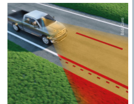
Aktive Spurhaltesysteme greifen aktiv in die Lenkung ein.
