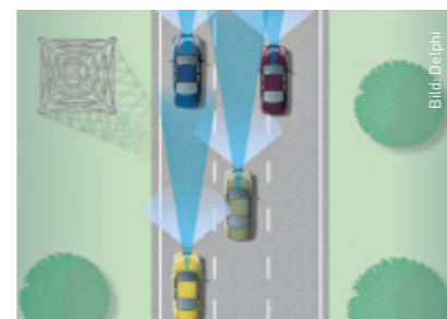
Praktischer Assistent: Adaptive Cruise Control (ACC) kombiniert mit Stop-and-go-Funktion.
