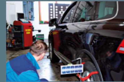
1. Wie von der Kamerakalibrierung bekannt, muss das CSC-Tool auch für die Radarjustierung parallel zur Hinterachse ausgerichtet werden.
