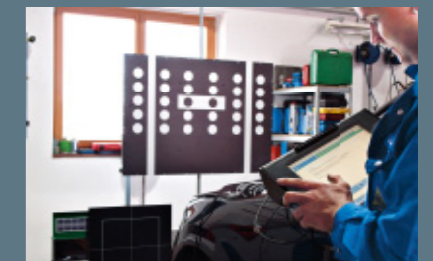
6. Für den vertikalen Abgleich des Sensors wird die Platte direkt vor dem Sensor zunächst in Stufe 1 positioniert. Die Messung wird über den mega macs initiiert.
