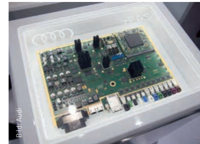
Im zentralen FAS-Steuergerät werden die Daten zahlreicher unterschiedlicher Sensoren und Kameras gesammelt und allen wichtigen Systemen zur Verfügung gestellt.
