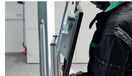
Im Schiebeschlitten des Systemhalters, der auf dem Justagebalken eingehängt wird, lässt sich wahlweise die neue Winkelverstellplatte oder die Kalibriertafel für Laserscanner einschieben.
