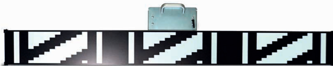
Die neue Kalibriertafel für Laserscanner an Audi-Modellen.
